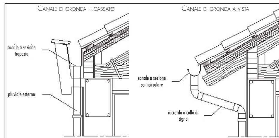
Tipologie di canali di gronda
