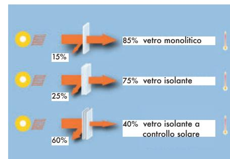
Efficienza del vetro a controllo solare rispetto ad altre tipologie sul mercato da <https://www.infissi.com/vetri/riflettenti-e-controllo-solare.html>
