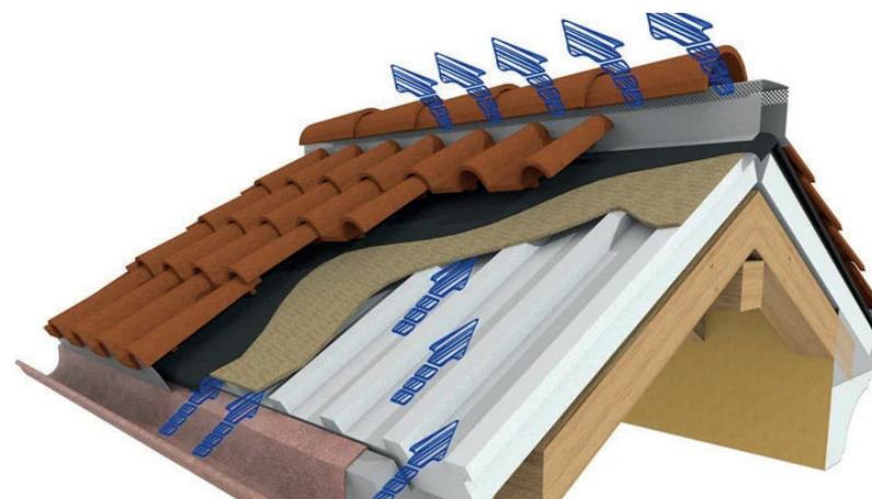
TETTO VENTILATO: passaggio dell'aria attraverso l'intercapedine di un tetto ventilato
