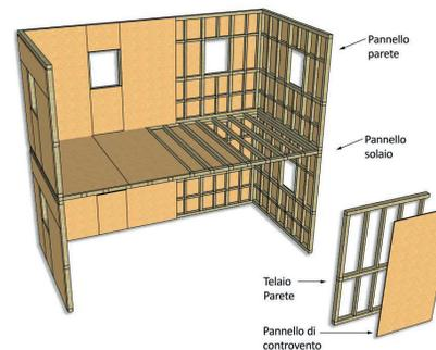
Schemi struttura Platform Frame da <https://www.costantinilegno.it/chi-siamo/tecnologia-balloon-frame-platform-frame/> <https://www.ingenio-web.it/25473-le-costruzioni-a-telaio-leggero-oggi-platform-frame>
