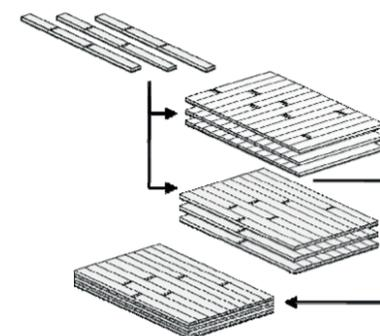
Schema di costruzione del pannello X-LAM
