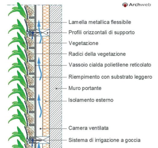
Parete vegetale su vassoi in polietilene reticolato ancorati alla parete tramite supporti di acciaio. Nello spazio tra il muro e la parete vegetale c'è l'isolamento termico e lo spazio per la ventilazione
