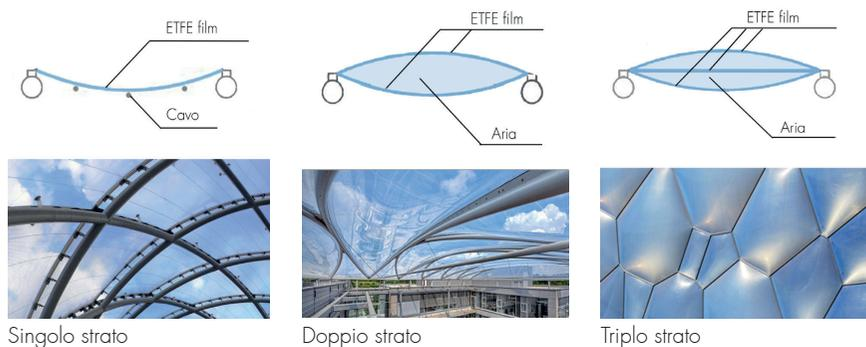
Sezione ETFE singolo, doppio e triplo strato
