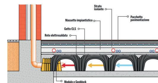
Dettaglio di solaio su vespaio aerato da <https://www.rifarecasa.com/ristrutturare/isolamento/vespaio-aerato>
