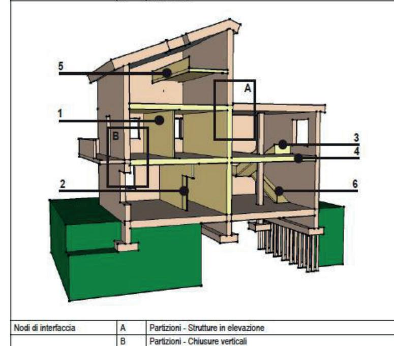
Scomposizione delle classi di unità tecnologiche "partizioni interne" da <http://www.unife.it/architettura/im.architettura/insegnamenti/materiali-e-progettazione-di-elementi-costruttivi/materiale/materiale-didattico-integrativo/estratto-lez-02-sistema-tecnologico>
