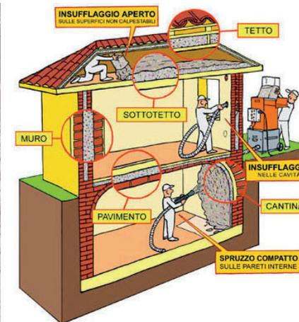
Edificio isolato con fibra di cellulosa
