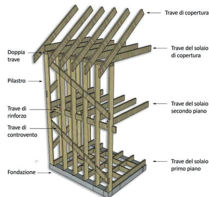
Schemi struttura Balloon Frame da <https://www.costantinilegno.it/chi-siamo/tecnologia-balloon-frame-platform-frame/> <https://www.ingenio-web.it/25473-le-costruzioni-a-telaio-leggero-oggi-platform-frame>
