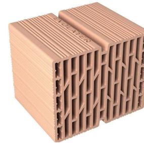
Blocco in laterizio per tamponamento, dimensioni: 30, 35 e 40 cm con massa superficiale superiore a 230 kg/m<sup>2</sup>, con ottime prestazioni termoacustiche da <https://www.edilportale.com/prodotti/pareti-esterne-e-facciate/blocchi-pannelli-e-lastre-per-pareti-esterne/blocchi-da-muratura-in-laterizio/91>
