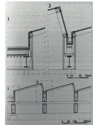
Sezione verticale e particolari costruttivi di una copertura trasparente a shed in vetro e acciaio
