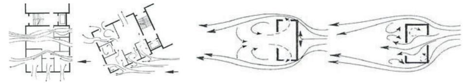
Dimostrazione di orientamento dell'edificio per sfruttare il vento
