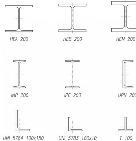
Sezione trasversale di alcuni profilati
