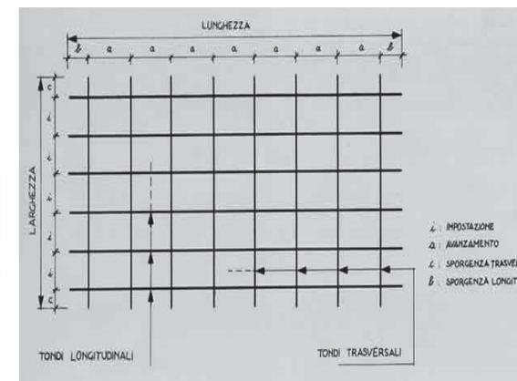
Caratteristiche delle reti elettrosaldate
