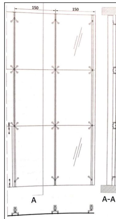
Sezioni e prospetto di una vetrata con dispositivi di fissaggio a crociera
