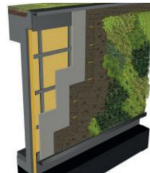
Dettaglio tecnologico tridimensionale della parete verde ideata da Patrick Blanc da https://unikore.it/phocadownload/userupload/f2201fa35c/Lez_4_Lab_Costr_Arch_involucro%20verde.pdf
