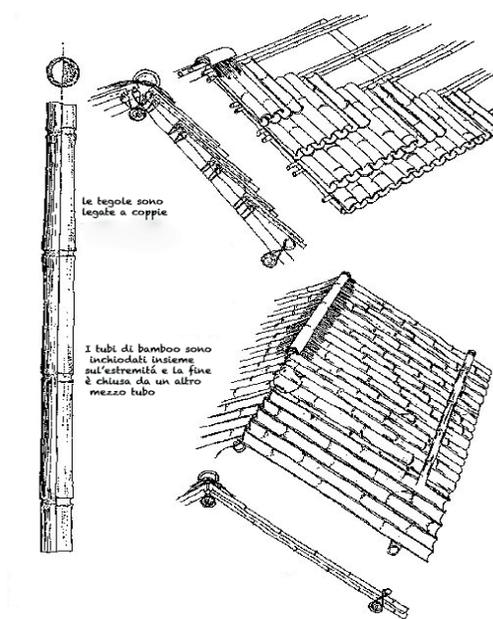
Schema di un tetto di bambù
