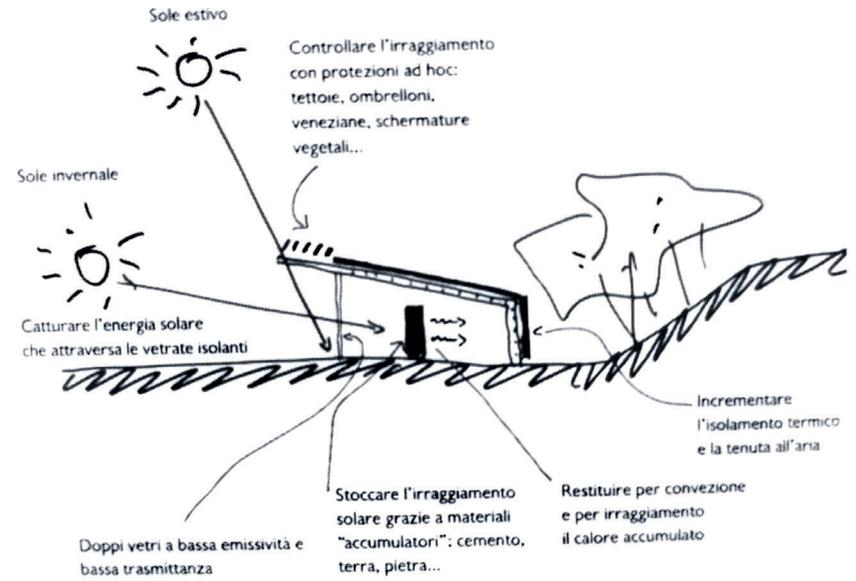
Chiusure e principi della bioclimatica
