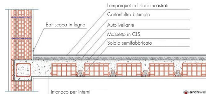
Esempio di solaio in laterocemento
