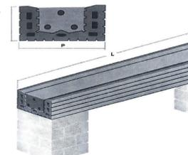
Architrave prefabbricato in laterizio con tondini di armatura inseriti nel getto di calcestruzzo da Campioli A., Lavagna M. (2013), *Tecniche e architettura*, Città studi
