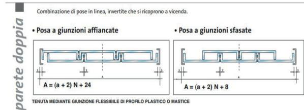
Schemi di posa dei moduli U-Glass da <http://img.edilportale.com/catalogs/prodotti-72557-cataa79eb777d87492a-90871318076305a9.pdf>
