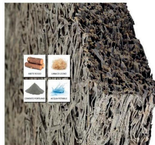
Particolare delle fibre del legno
