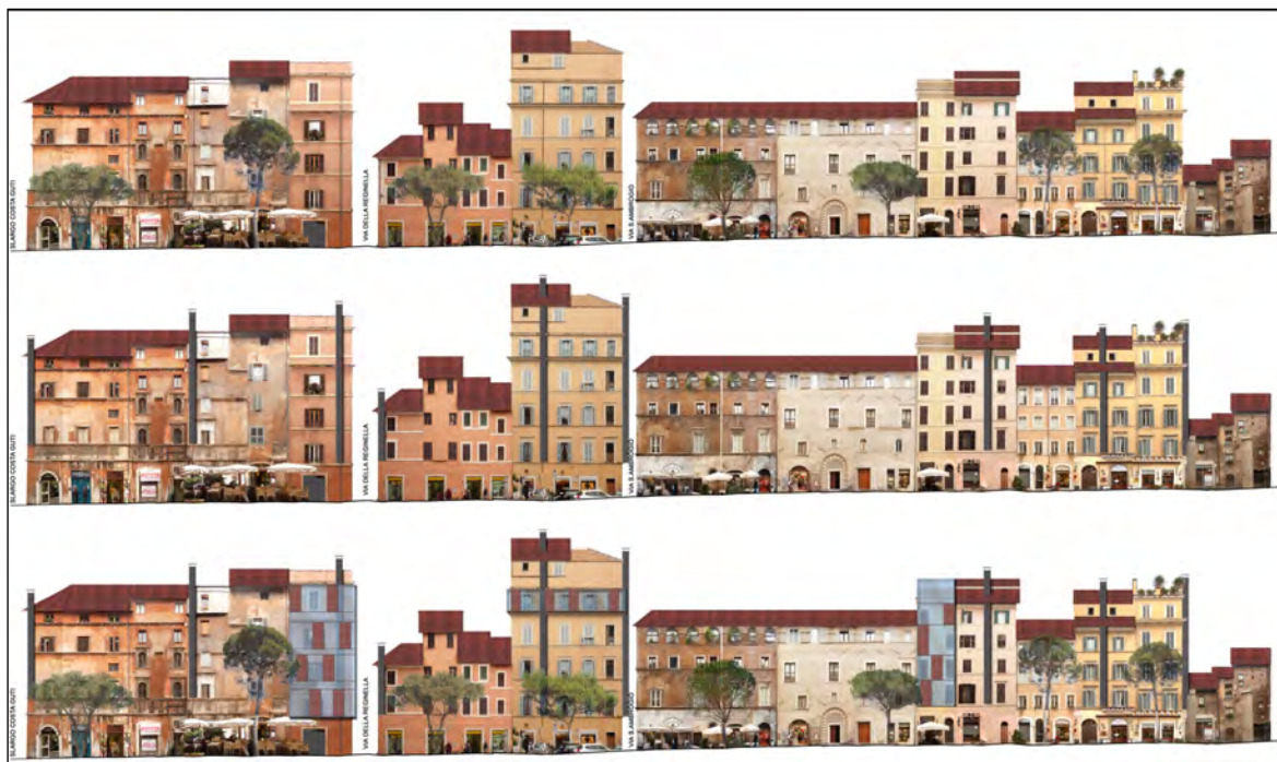
Fig 2 | Roma, ghetto ebraico, il fronte urbano di del Portico di Ottavia. Simulazioni di analisi per la valutazione di interventi di rigenerazione energetica. Dall'alto: vegetazionale al basamento con sistema dissimulato in copertura; camini di ventilazione con sistema dissimulato in copertura; vegetazionale al basamento, sistema dissimulato in copertura, camini di ventilazione con serre solari in facciata. Da: Cennamo, 2014.
