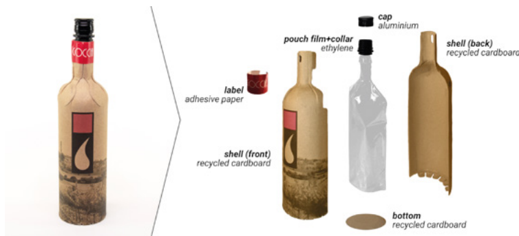
Fig. 2 Example of a packaging disassembly visualisation by Pera S., Salazzari F., Signetti A., Solavaggione M., Tilocca D., Valperga L., 2021.
