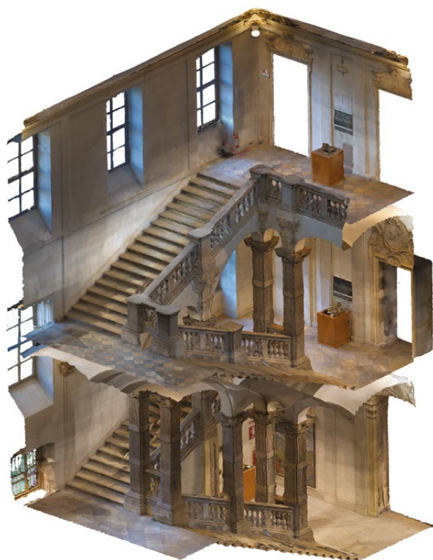
fig. 9 – Restituzione assonometrica di precisione dello scalone principale dell'Ospedale Maggiore su base integrata del rilevamento LiDAR e fotogrammetrico. Si apprezzano in particolare la sequenza ritmica dei pilastri, dotati di ordine, a reggere il sistema voltato; i pianerottoli presentano una pavimentazione in materiali selezionati analoghi a quelli scelti per l'atrio, mentre la sezione sull'assonometria permette di apprezzare gli stucchi che formano cornici di ricca impostazione in corrispondenza dell'accesso alle infermerie (elaborazione di M. De Chiaro e P. Guerreschi, 2020).
