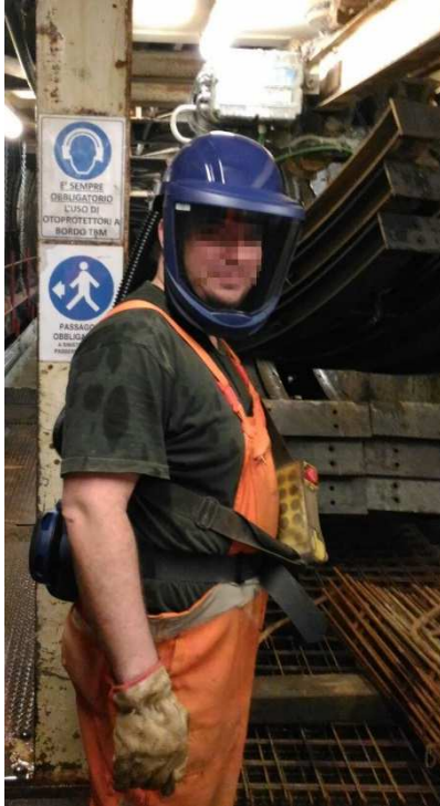
Figure 5. Casque à visière Sundstrom Safety(R) SR 580 et unité de ventilation Sundstrom Safety(R) SR 500
