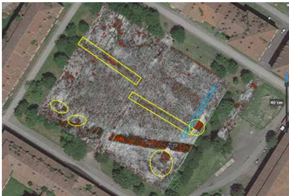
3. timeslice a una profondità stimata di 0.4 m per profili VV (velocità di propagazione 0.07 m/ns). Elaborazione con software IQMaps. Le aree con i contorni gialli e azzurro evidenziano gli eventi di maggior interesse // timeslice at an estimated depth of 0.4 m for VV profiles (propagation velocity 0.07 m/ns). Processing with IQMaps software. The areas outlined in yellow and blue highlight the most interesting events.
