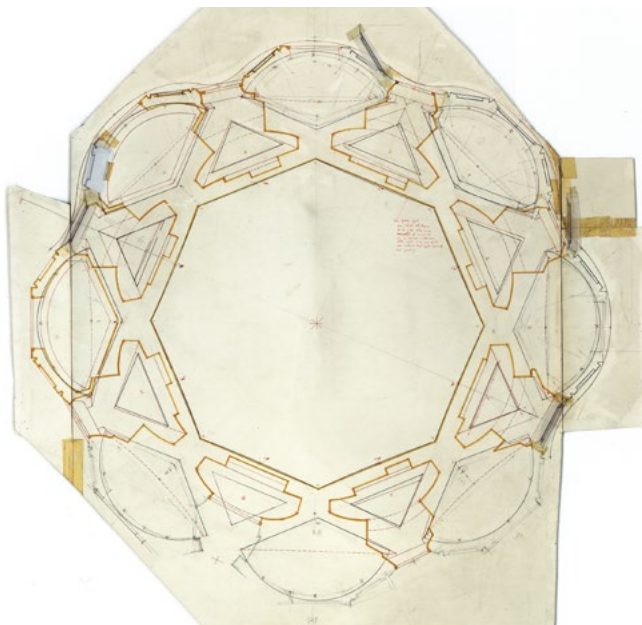
Figura 3. Pianta della cupola della chiesa di San Lorenzo, scala 1:20. La stesura del rilievo come costruzione di un progetto: disegno su carta da disegno, la stratificazione dei segni, a matita nera dura per l'impostazione, lo sviluppo con colore quando utile, le correzioni. Disegno su carta Fabriano: tracce di cartoncino per puntare ripetutamente il compasso senza danneggiare il foglio, note minute a matita. © Fondo Franco Rosso, Archivio di Stato di Torino.
