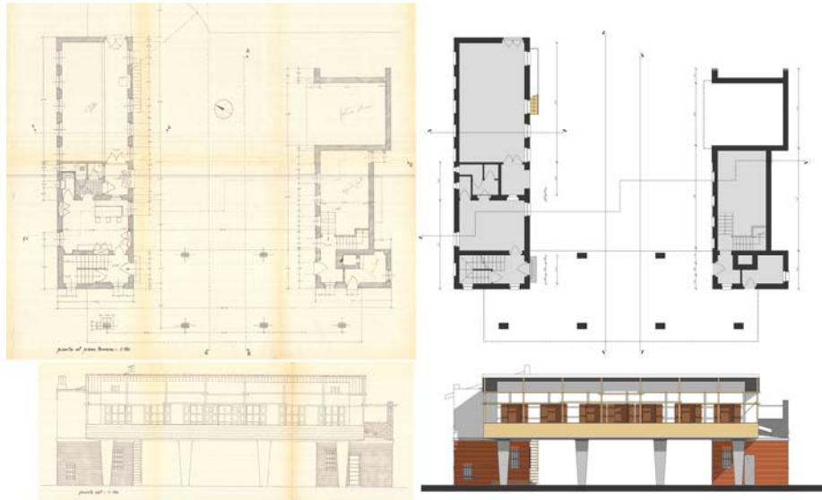
Fig. 8. Archival drawings and BIM modelling of Cascina Treves-Sacerdote. (Archivi BCA. Fondo Aldo Morbelli, BIM Modelling: F. Natta).
