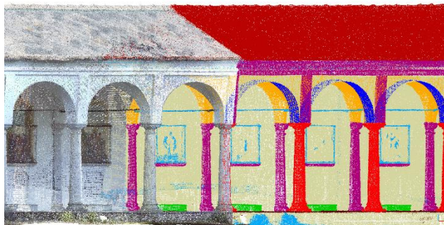
Figura 6. Esempio di modanature (viola) e colonne (rosso).
