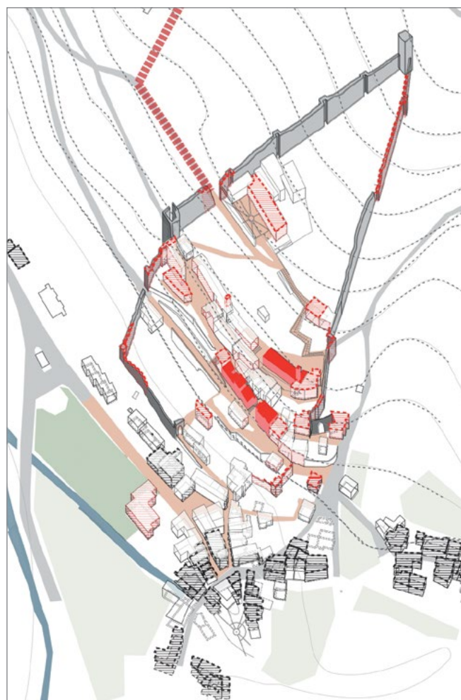
Figura 10. Schema delle ipotesi di intervento del borgo storico con evidenziati in rosso i volumi edilizi e le porzioni di mura da recuperare e in tratteggio i volumi distrutti di cui lasciare traccia nel basamento (elaborazione grafica di I.Tonti e E.Torricelli).
