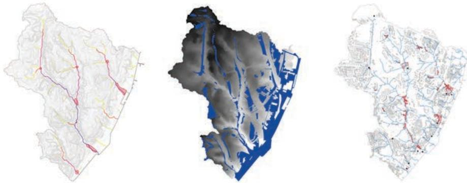
Figura 4 | Nella mappa a sinistra vengono rappresentate le principali aree d'infiltrazione, nella mappa centrale le aree potenzialmente permeabili e nella mappa a destra gli edifici localizzati in aree di deposito naturale. Fonte: elaborazione dell'autore su cartografia CML.
