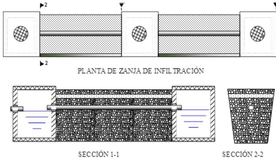
**Figura 6. Croquis de la zanja de infiltración diseñada para el sector S4**
