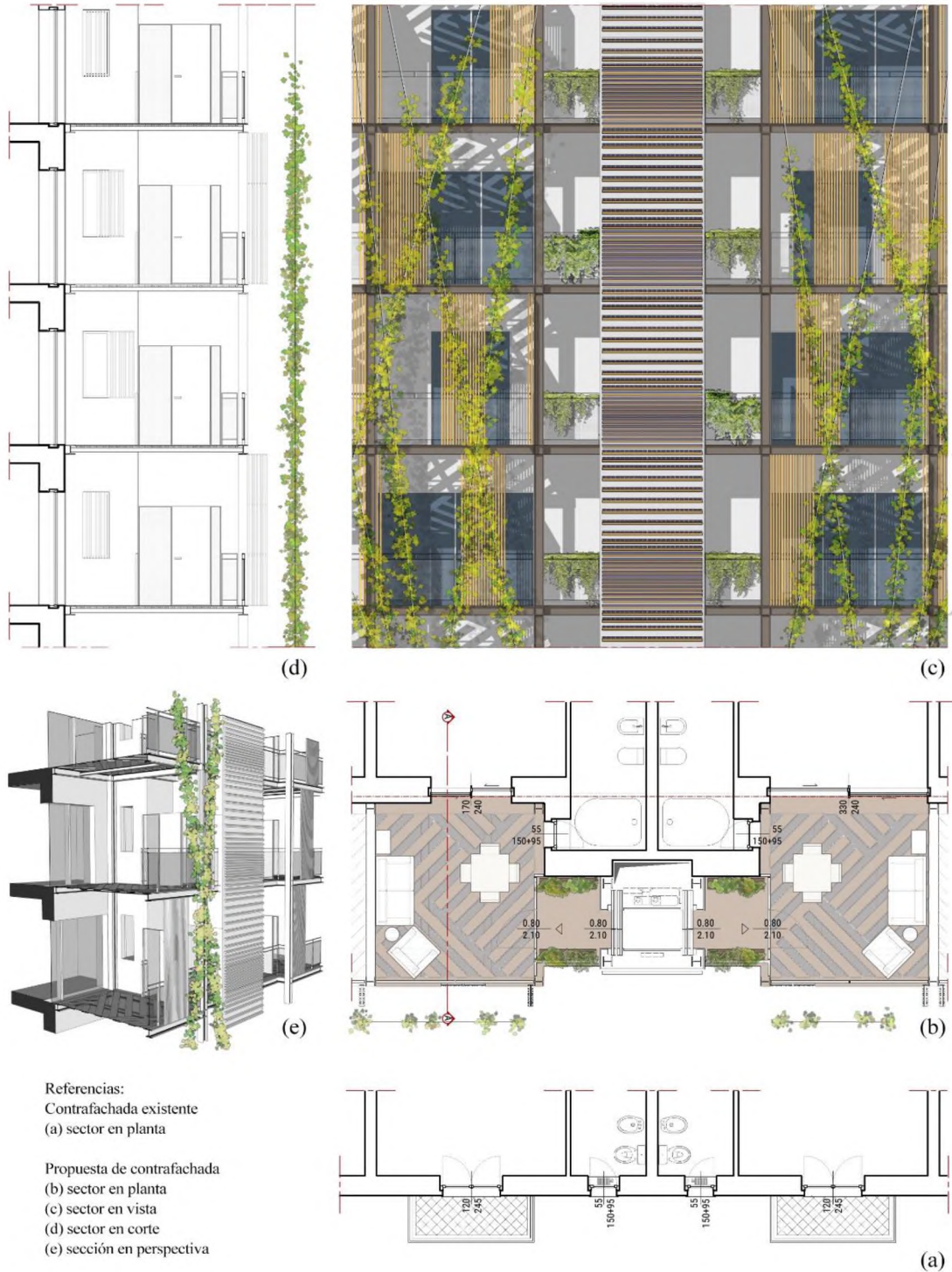
Figura 1: ejemplo de remplazo de envoltorio vertical posterior. Fuente: elaboración propia.
