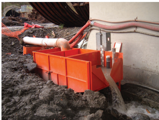
Fig. 11 - Stazione di misura della portata drenata all'imbocco di una galleria in costruzione.
