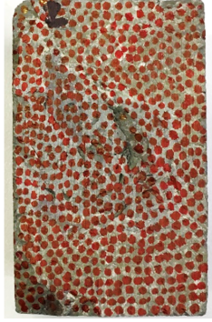
Figure 6.43: Homogeneous specimen n.1 speckled for the DIC analysis.
