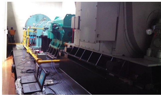
Fig. 11. The centrifugal compressor test-rig.
