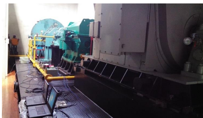
Fig. 11. The centrifugal compressor test-rig.
