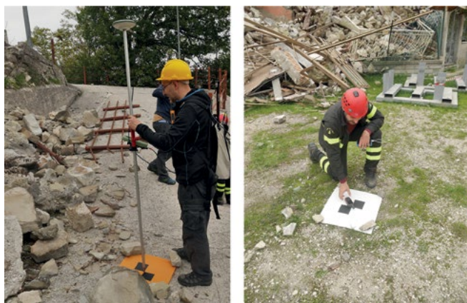
Figura 6. Alcune delle operazioni di misura sul campo dei punti di controllo tramite sistema GNSS in RTK mode (sinistra) e tramite palmare GNSS (destra).
