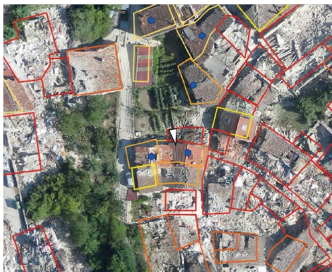
Figura 14. Integrazione dei dati UAVs per il BDA. L'edificio selezionato (indicato nell'immagine a sinistra con freccia bianca) non presentava danni evidenti nella sola ortofoto mentre si è rivelato essere gravemente danneggiato a seguito di un'ispezione del modello 3D (a destra).
