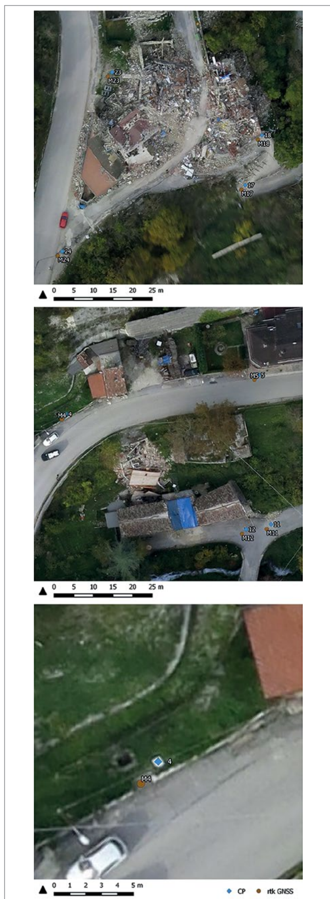
Figura 12. Estratti delle ortofoto con indicato lo scostamento tra i punti misurati con ricevitori GNSS in RTK mode e i CPs del progetto elaborato con i dati del geotag.
