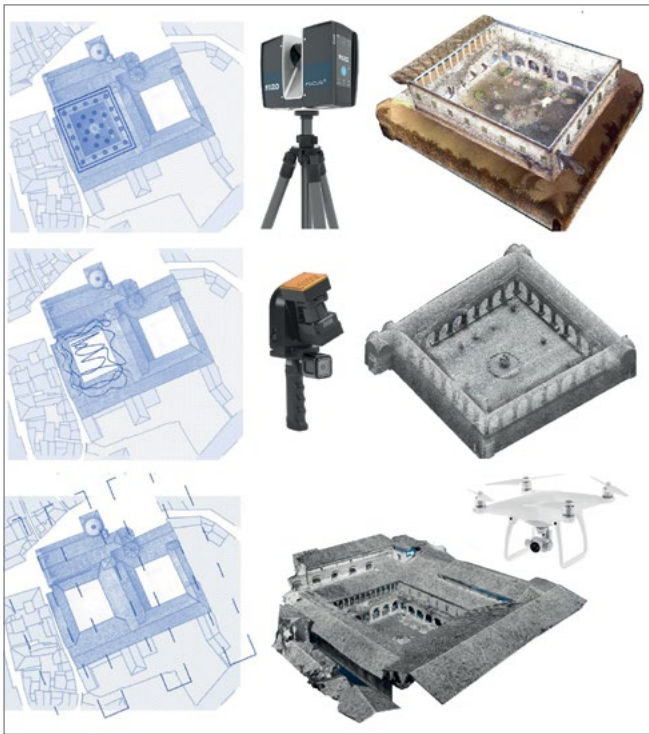
Figura 4. I tre sistemi testati: laser scanner Faro Focus 3D, Zeb Revo di GeoSLAM e fotogrammetria UAV con il Phantom 4 DJI.
