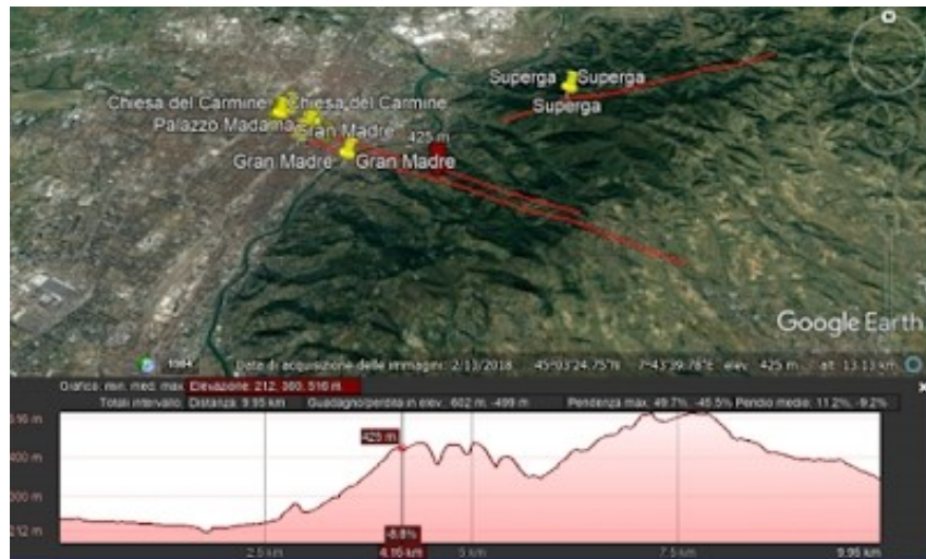
Fig. 3 : Dal centro della Torino Romana si traccia una retta che segue la direzione del decumano massimo (oggi Via Garibaldi), fino a superare le colline. Google Earth ci fornisce un profilo d'elevazione, da cui estrarre i dati. Da un semplice calcolo si trova l'altezza che deve avere il sole per essere visto sorgere sull'orizzonte fisico. Se si è in loco e se si ha a disposizione un clinometro, la misura diretta è preferibile perché più precisa. Si noti che l'orizzonte fisico è anche definito come orizzonte naturale, ossia la linea che rappresenta il profilo del paesaggio [23,24].
