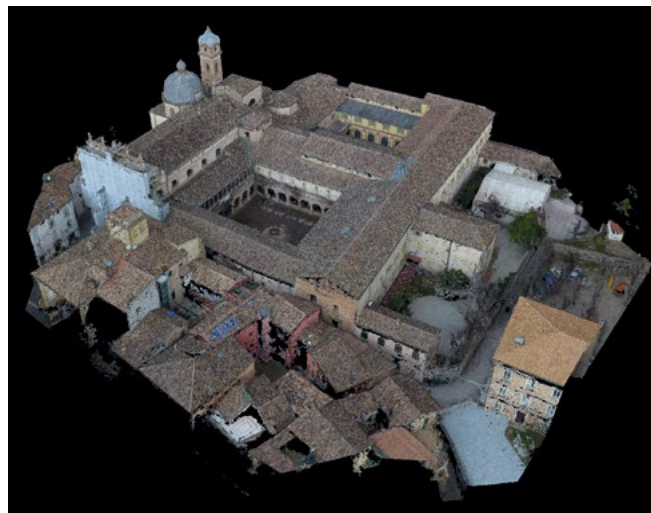
Figura 6. Vista della nuvola 3D complessiva, derivata da fotogrammetria UAV (Unmanned Aerial Vehicle).
