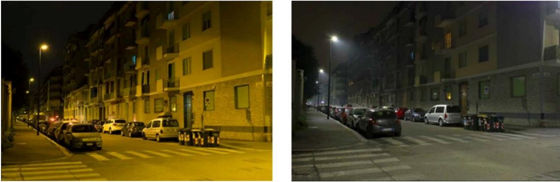
Figura I.40 - Torino. Sostituzione delle sorgenti di illuminazione a vapori di sodio ad alta pressione con sorgenti LED. (Fotografie di Kimo Dogani)
