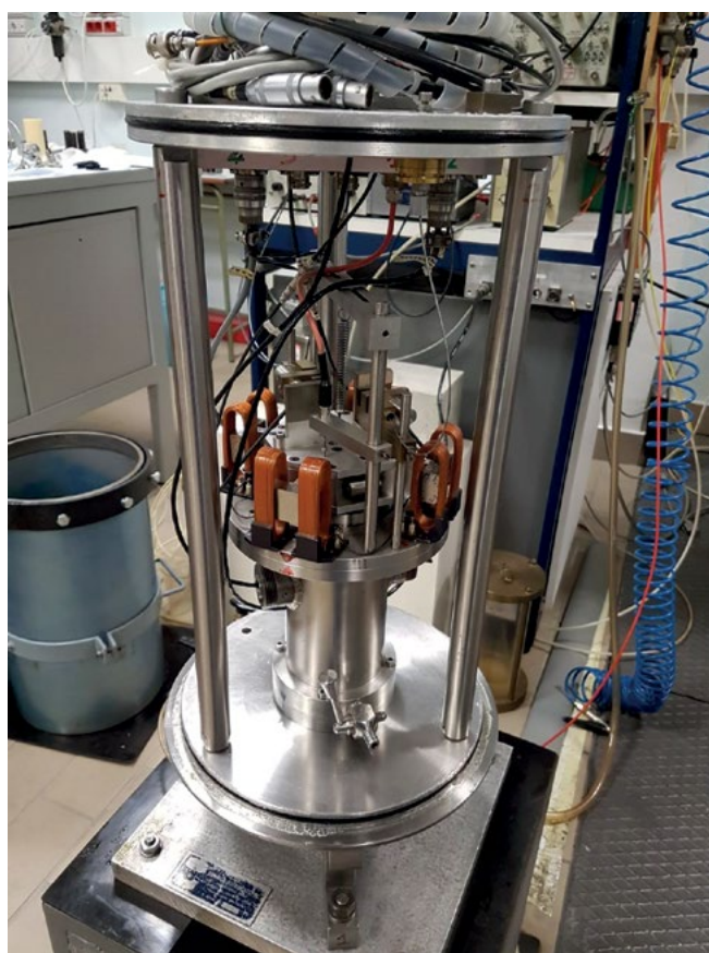
Figura 3. Apparecchiatura per l'esecuzione di prove combinate di colonna risonante e taglio torsionale ciclico.
