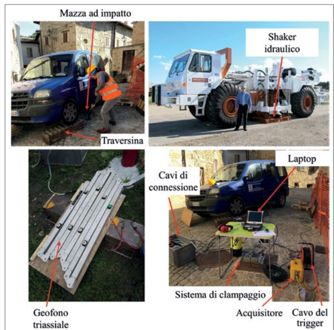
Figura 8. Immagini delle varie attrezzature utilizzate per una prova Down-Hole (DH).
