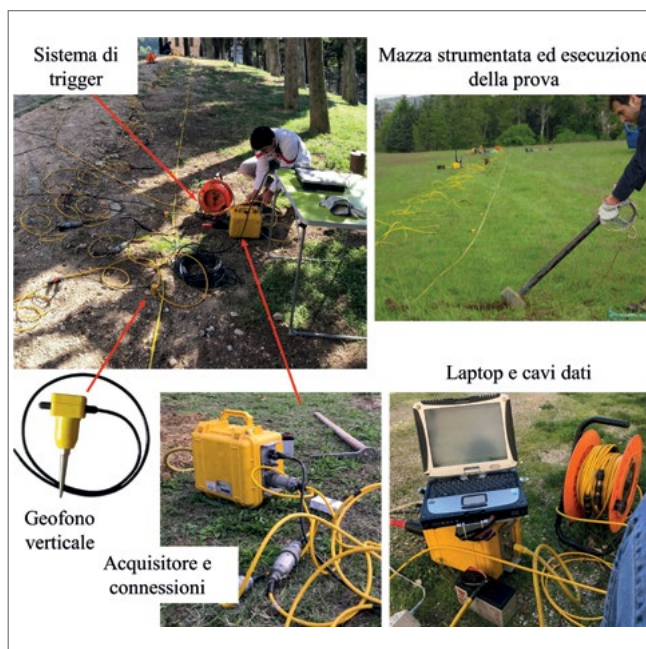
Figura 6. Illustrazione di una prova MASW (Multichannel Analysis of Surface Waves) attraverso i vari strumenti generalmente utilizzati per scopi di microzonazione sismica.
