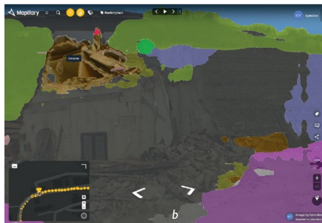
Figura 10. Esempio di un'immagine terrestre acquisita a Pescara del Tronto nel Dicembre 2018 (a) e il risultato del processamento di segmentazione automatica della piattaforma Mapillary (b) in cui la porzione di edificio rimasta in piedi è classificata come "Building" (grigio) mentre quella crollata come "Dynamic" (marrone chiaro). Fonte: https://www.mapillary.com/appl/ .
