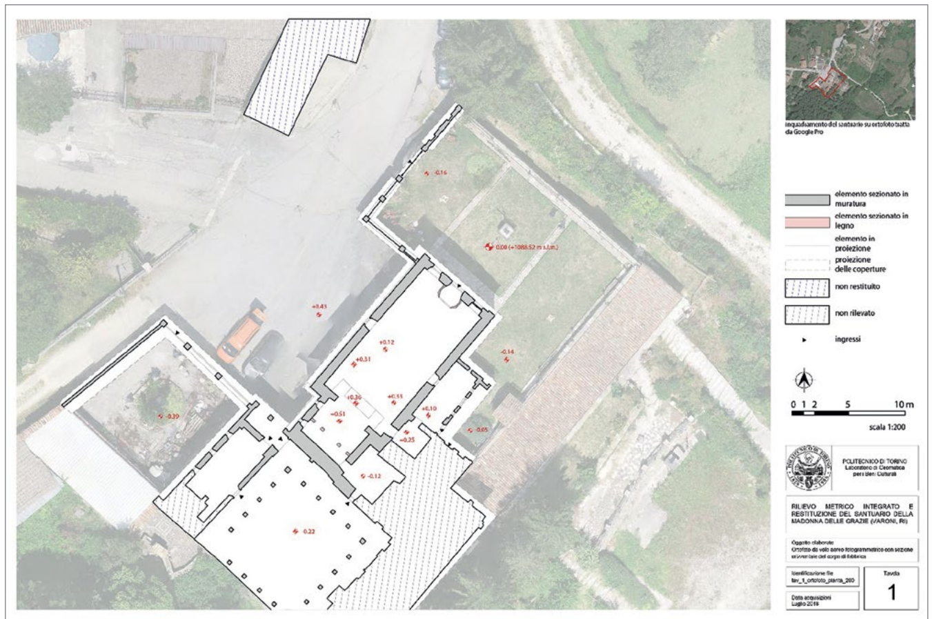
Figura 12. Planimetria del complesso, restituita alla scala 1:200, sovrapposta all'ortofoto nadirale.
