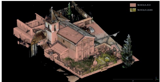
Figura 11. Integrazione delle nuvole derivate dal volo UAV e dal sistema di mapping mobile Zeb Revo.
