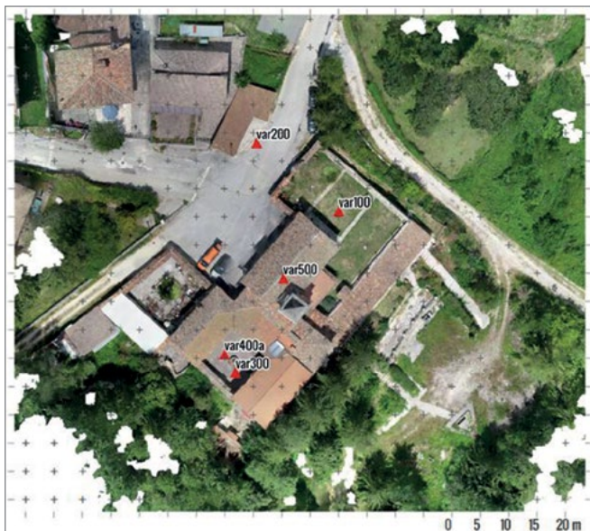
Figura 5. Schema della rete topografica principale: impianto di 5 vertici topografici, fra i quali uno all'interno della chiesa.
