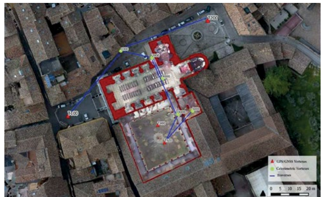
Figura 9. Rete topografica di raffittimento determinata con tecnica classica, mediante stazione totale (vertici distribuiti nella chiesa, nel chiostro e nel cappellone).
