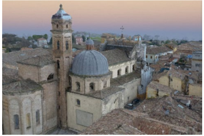
Figura 11. Nuvola di punti densa generata utilizzando le strisciate di fotogrammi nadirali e inclinati.
