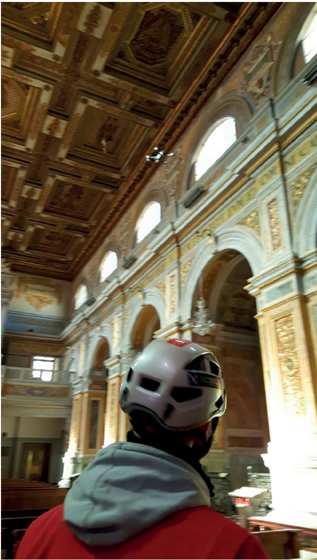
Figura 5. Test di volo con micro-droni all'interno della navata per riprese video finalizzate a ispezioni ravvicinate sulle lesioni e per acquisizioni di fotogrammi destinati ad applicazioni fotogrammetriche (i piloti UAV della campagna del febbraio 2017 sono stati P. Maschio, F. Chiabrando e L. Teppati, rappresentato in foto).
