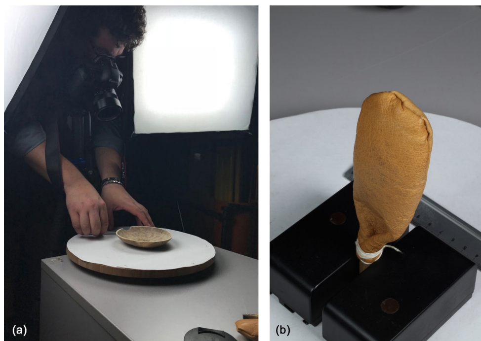
Fig. 6.3 (a) Fase di acquisizione. Lo stage è stato allestito in modo che l'illuminazione fosse adeguata e distribuita omogeneamente (grazie ai due fari LED posizionati a lato della camera). (b) Esempio di utilizzo di supporti per l'acquisizione di un'immagine digitale. In questo caso, a sostegno dell'oggetto, è stata utilizzata una coppia di supporti posizionati alla base dello strumento (uno dei due quaglieri ).
