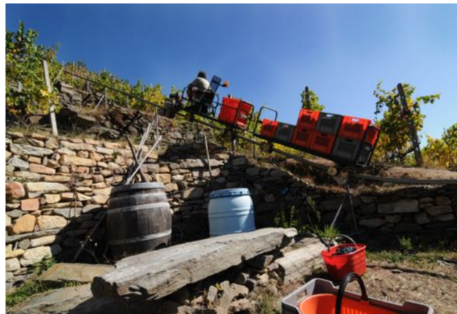
05 Viticulture héroïque: le monorail de Pomaretto (TO), construit en 2003 pour faciliter la cultivation des vignes en forte pente | Viticoltura eroica: la monorotaia di Pomaretto (TO), costruita nel 2003 per facilitare la coltivazione nei vigneti in forte pendenza.
