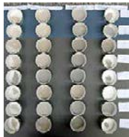
fig. 53 – Risultato finale della disgregazione dei campioni nelle classi tra 0,25 mm (destra) e <0,063 mm (sinistra).
