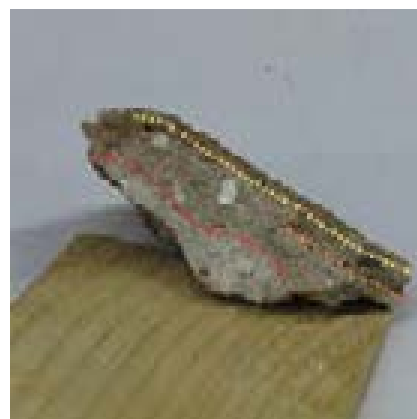
fig. 45 – Il campione di malta A con evidenziati gli strati di cui è composto.
