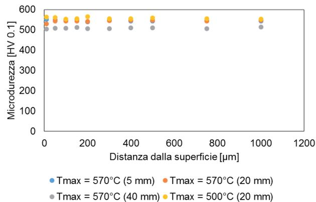
**Fig. 6** – Valore medio dei profili di microdurezza per sezioni profondità crescente dei campioni sottoposti a ciclaggio termico / Average microhardness profiles of thermal cycled samples for increasing furnace depth.
