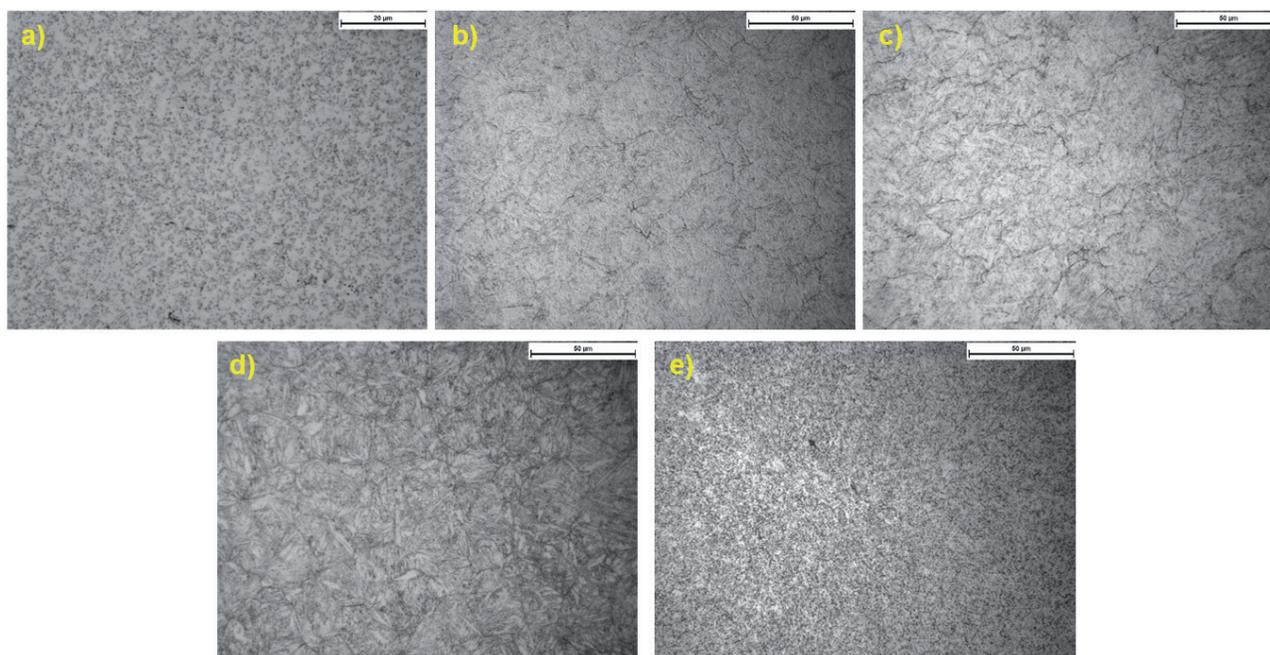
**Fig. 4** – Micrografie dell'acciaio AISI H13 modificato, nei diversi stati microstrutturali a) ricotto, b) bonificato, e dopo mantenimento in forno per 50 h a c), 500°C d) 570°C, e) 650°C / Micrographs of the modified AISI H13 steel in the two metallurgical states a) annealed, b) quenched and double tempered, and after hoding in furnace for 50h at c) 500°C, d) 570°C, e) 650°C.
