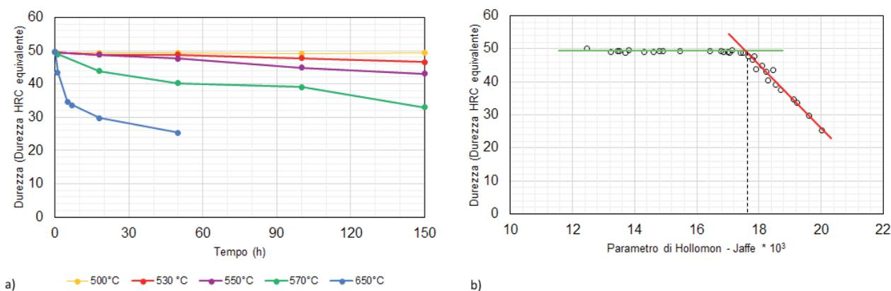
**Fig. 3** – Curva di addolcimento in relazione al parametro di Hollomon – Jaffe per l'acciaio AISI H13 modificato / Softening curve of the modified AISI H13 steel as a function of the Hollomon – Jaffe parameter.
