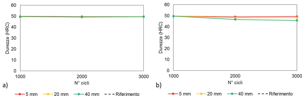
**Fig. 5** – Durezza in funzione del numero di cicli termici, a)  $T_{max} = 500^{\circ}C$ , b)  $T_{max} = 570^{\circ}C$  / Hardness as a function of the number of thermal cycles, a)  $T_{max} = 500^{\circ}C$ , b)  $T_{max} = 570^{\circ}C$
