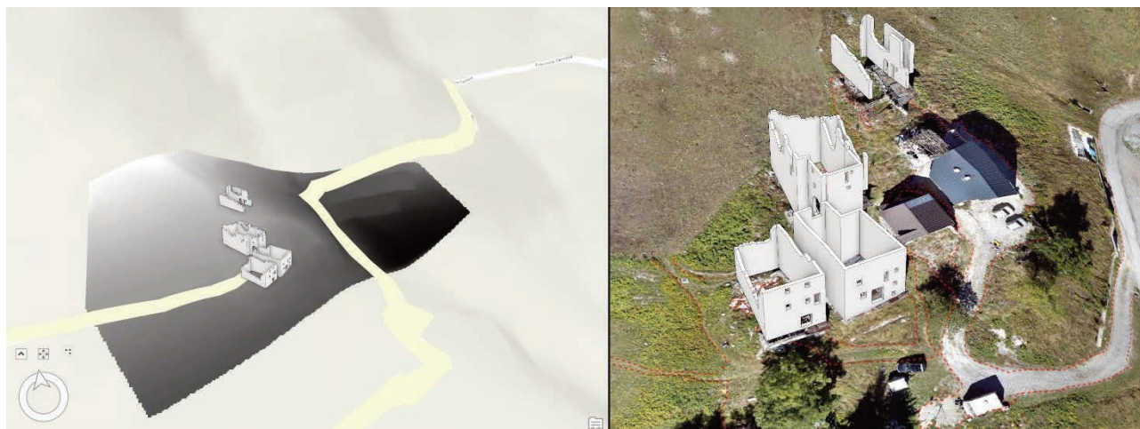
Figura 4. Visualizzazione del modello BIM in ambiente GIS.
