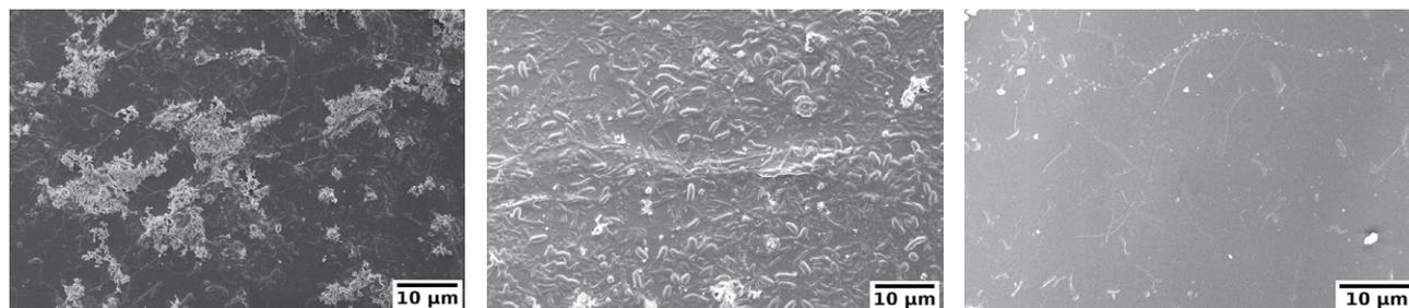
**Fig. 2** - Immagini SEM della superficie dei rivestimenti contenenti nanoparticelle di argento in seguito a immersione in soluzione di acque reflue, da sinistra: 0% - 1% - 3% in peso di  $\text{AgSbF}_6$  / SEM images showing Ag-doped epoxy coatings after immersion in wastewater, from left: 0 wt% - 1 wt% - 3wt% of  $\text{AgSbF}_6$
