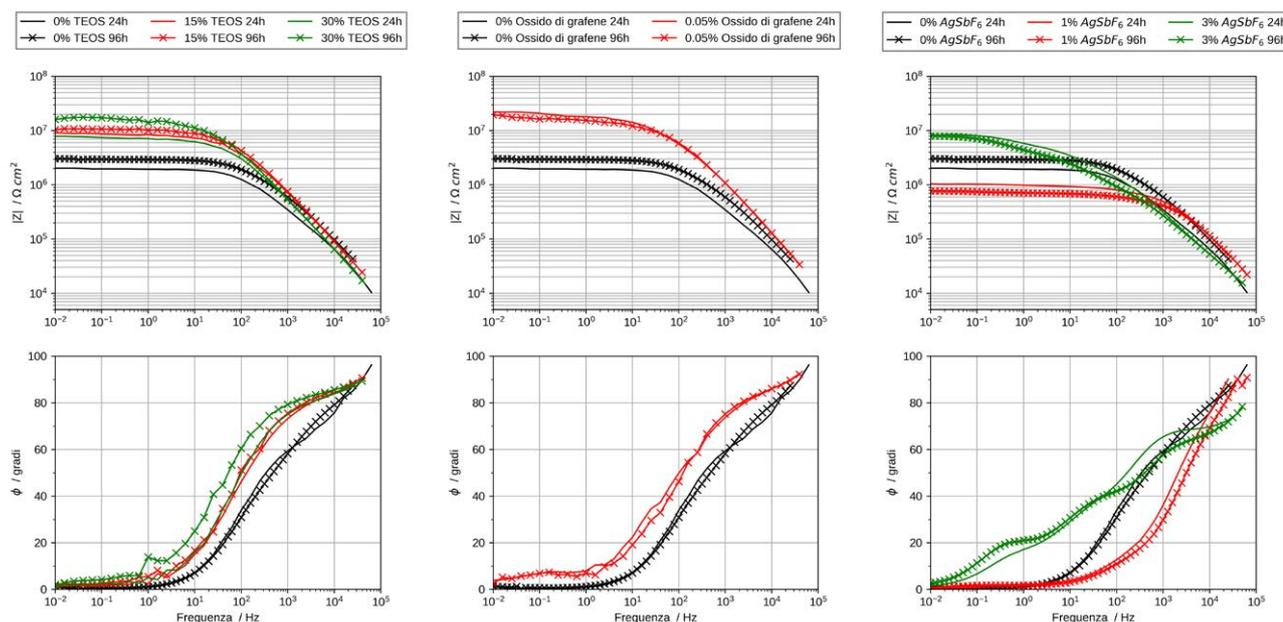
**Fig. 1** - Spettri di impedenza dei rivestimenti ibridi (con diversi contenuti di carica), confrontati con la resina epossidica non caricata, registrati dopo 24 e 96 ore di immersione in soluzione aerata di NaCl 0.1M / Impedance spectra for the three coatings (with different filler content), compared to the bare epoxy resin, collected after 24 and 96 hours of immersion in 0.1 M NaCl solution.
