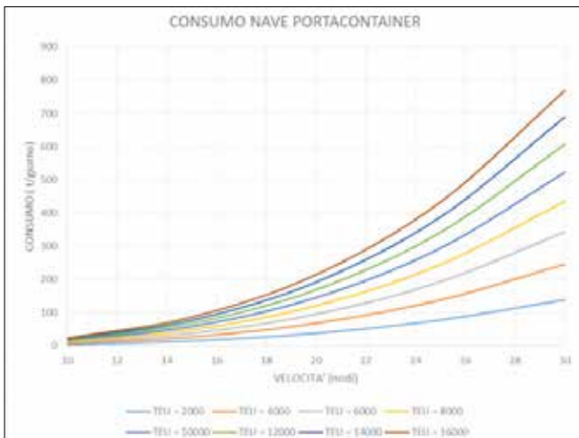
FIG. 12 ESEMPIO DI ANDAMENTO DEI CONSUMI, ESPRESI IN TBUNKER/GIORNO, DI UNA NAVE PORTACONTAINER AL VARIARE DELLA VELOCITÀ E DEL PESO (WWW.MATEMATICAMENTE.IT)
