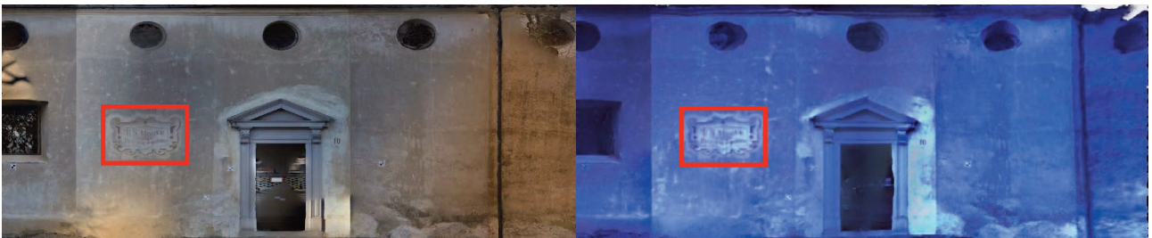
Figura 9 – Confronto tra due ortofoto (proiezione cilindrica) di una porzione del modello della cappella 10, generate a partire dal dataset fotogrammetrico aereo/terrestre (sinistra) e dal dataset della feature tracker camera (destra). In rosso, la porzione della superficie muraria riportata in dettaglio in figura 10.
