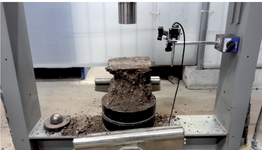
FIG. 2 Prova di compressione Unconfined compressive strenght test
