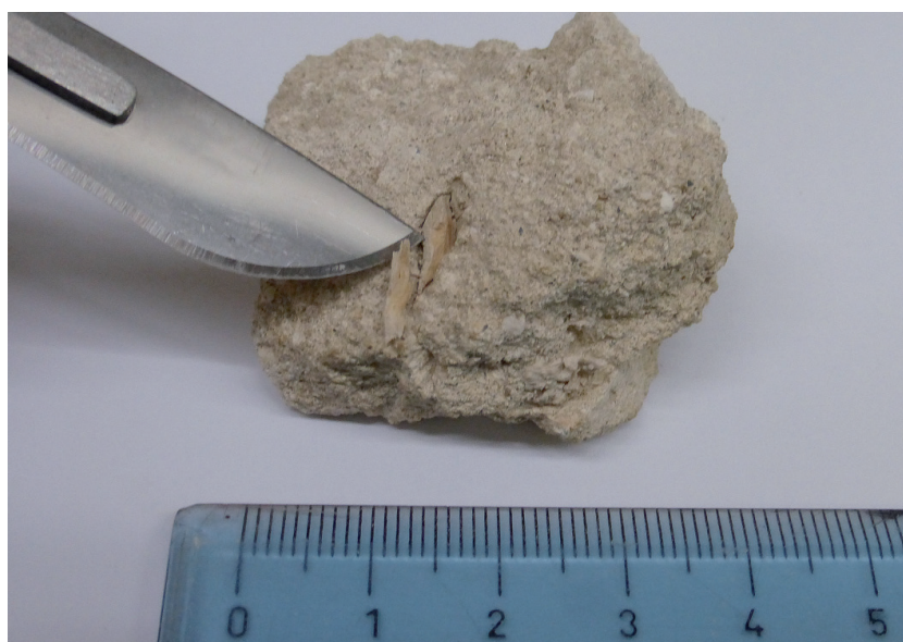
FIG. 2 Varoni, S. Maria delle Grazie. Particolare di campione di malta successivamente disgregata per analisi e riformulazione Varoni, S. Maria delle Grazie. Sample of mortar for analysis and re-formulation
