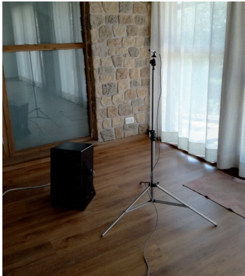
FIG. 2 Misurazione in sito delle prestazioni acustiche On-site measurement of acoustic performance
