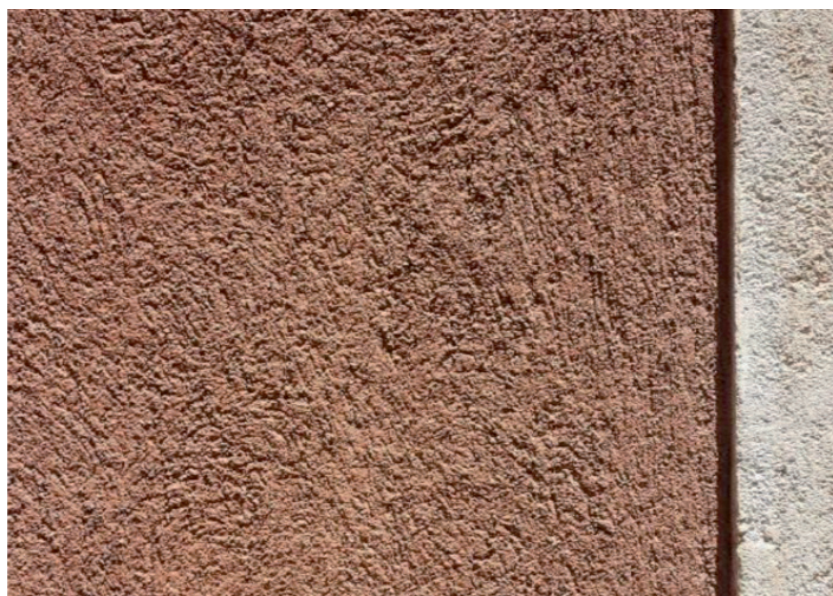
FIG. 2 Campione di malta naturale idraulicamente attiva priva di pigmenti artificiali Sample of hydraulically active natural mortar without artificial pigments
