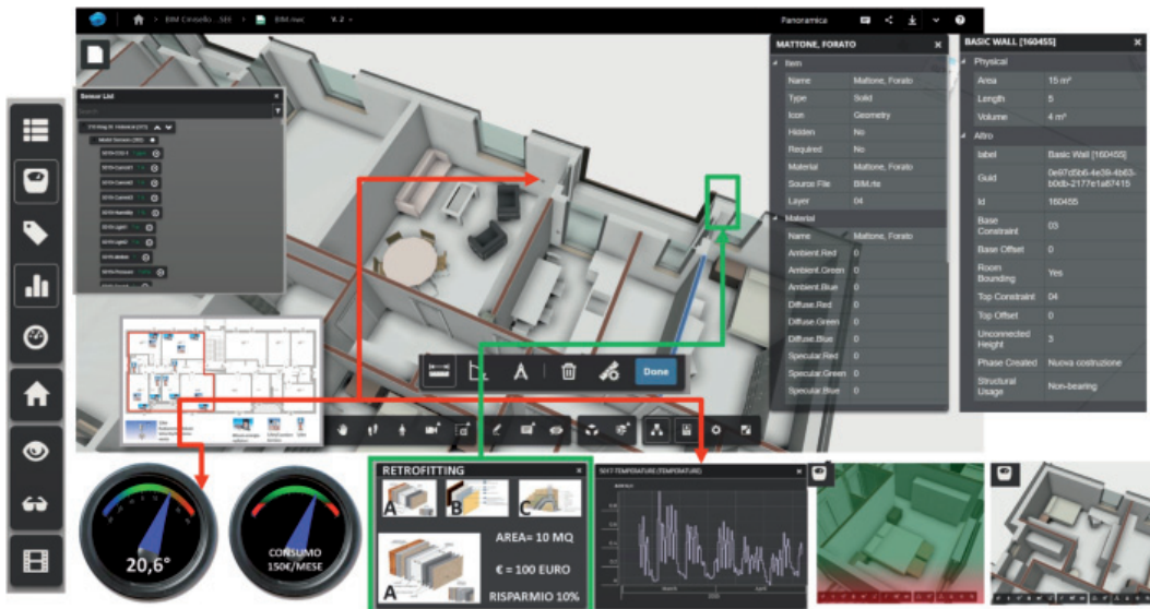
FIG. 2 Integrazione del disegno BIM con le informazioni in tempo reale derivate da sensori Integration between BIM and real time sensor data
