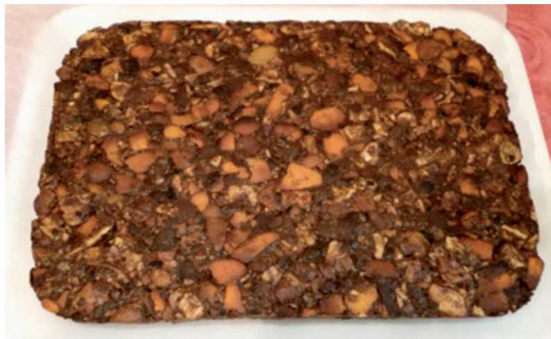
FIG. 2 Pannello sperimentale ottenuto dagli scarti di lavorazione degli agrumi Experimental panel obtained from the citrus fruit processing waste
