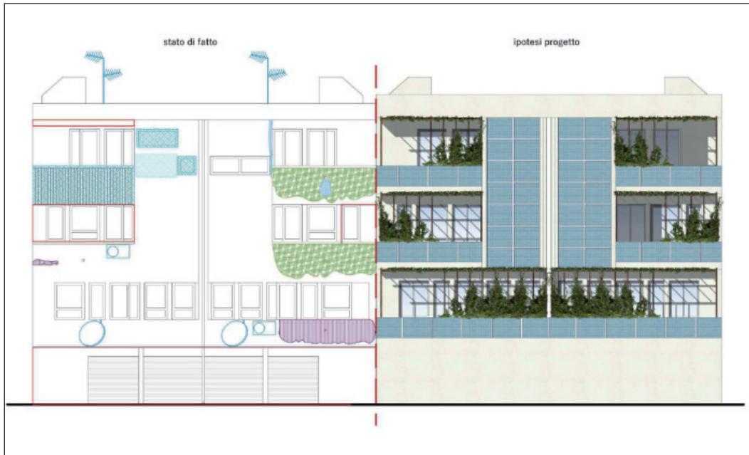
FIG. 1 Prospetto Sud-Est. Stato di fatto e proposta di riqualificazione South-East view. Current status and redevelopment proposal
