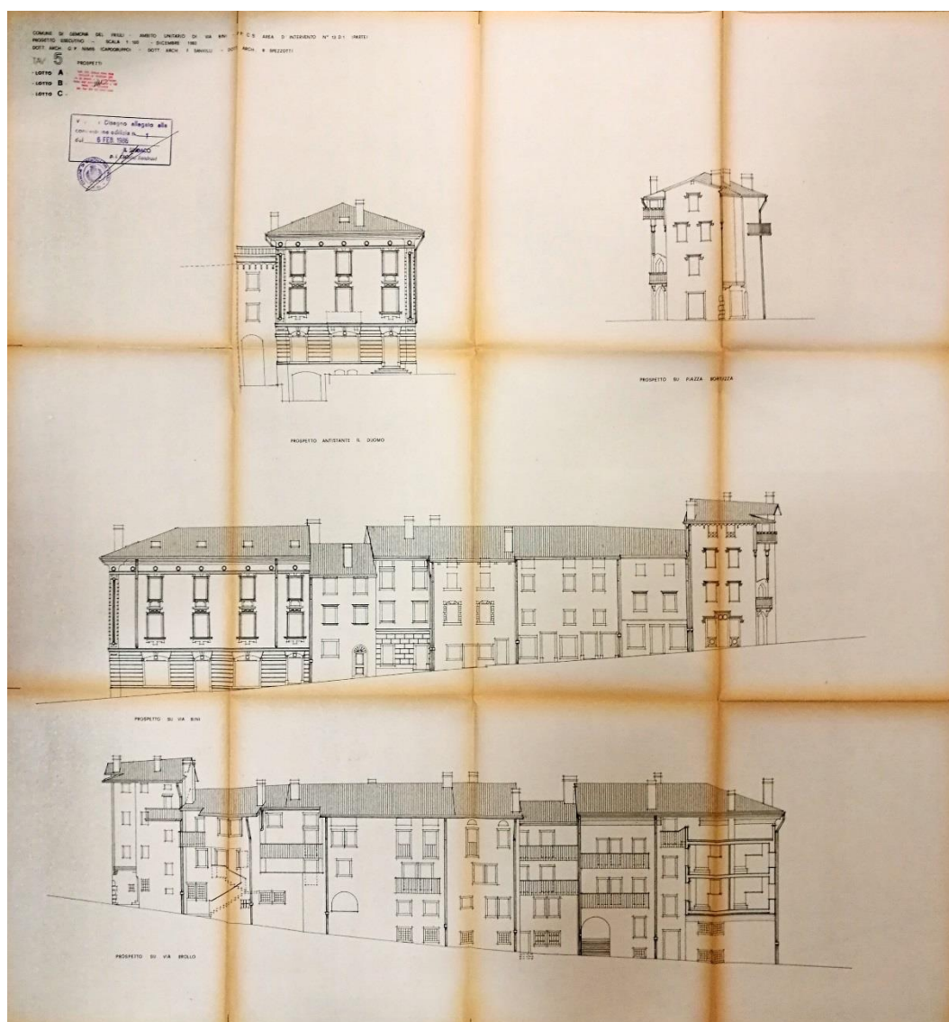
Figura 2.207 - Gemona del Friuli. Via Bini. Prospetti Area di intervento 13D1. Al ripristino filologico dei prospetti su piazza Portuzza, piazza del duomo, via Bini finalizzato alla riproposizione di ambienti emblematici si contrappose quello tipologico previsto su via Broлло. Fonte: Archivio Comune di Gemona del Friuli.
