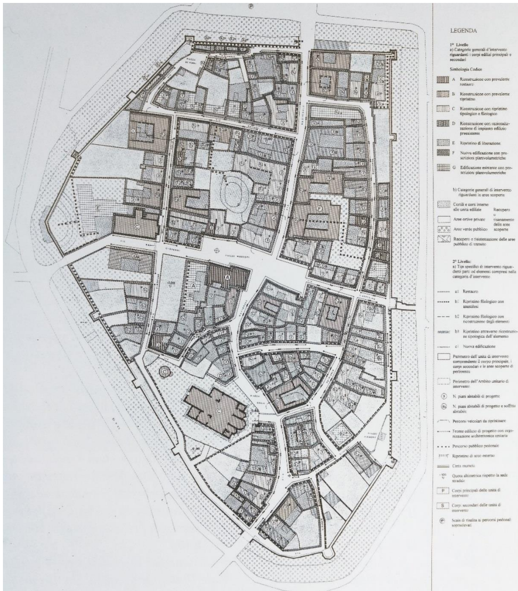
Figura 2.159 - Venzone. Piano Particolareggiato. Il Piano approvato nel 1980 si articolava in isolati e unità edilizie di intervento e consentì di coordinare la progettazione per comparti. Fonte: Bollettino dell'Associazione "Amici di Venzone", 2006, 34.
