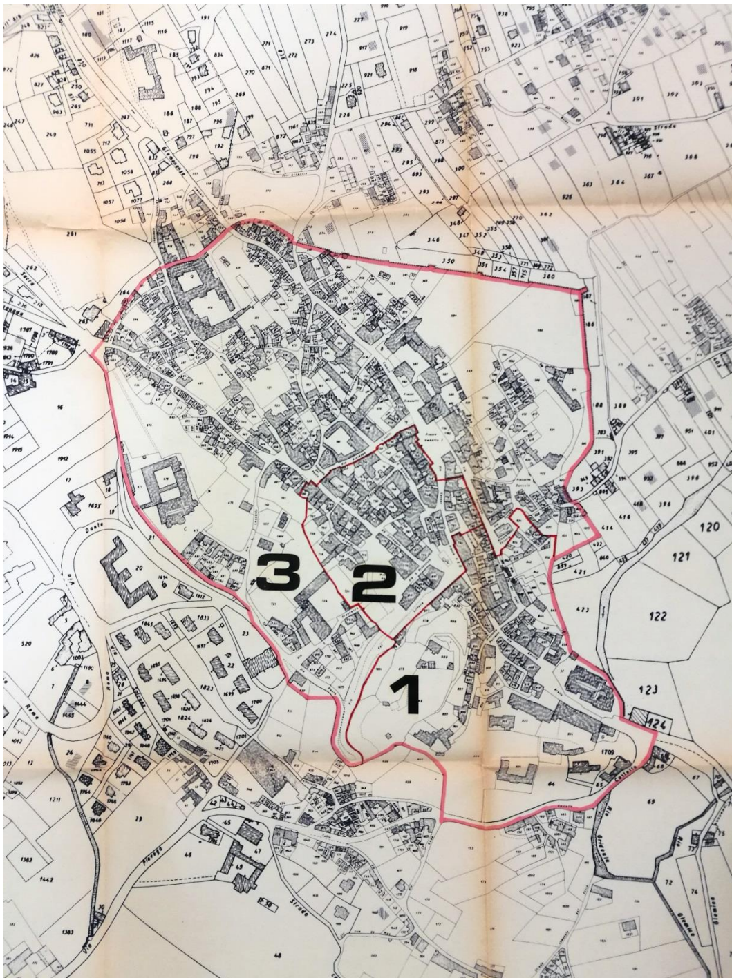
Figura 2.199 - Gemona del Friuli. Piano Particolareggiato Centro Storico di Gemona. La perimetrazione in settori a seguito del sisma di maggio individuò l'ambito di via Bini comprensivo del Duomo, del Municipio e del Castello quale settore l'area di massima conservazione. Fonte: Archivio Comune di Gemona del Friuli, P.P. - Perimetrazione del centro storico 1976.
