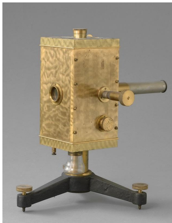
Fig. 3. New Leiss electrometer (Modello Perucca 1926) thin wire (inventory n. 50)
