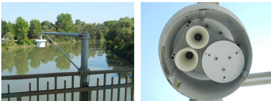
Figura 5: idrometro installato presso il ponte sul Po della SP122 Via Villastellone – Carignano (TO). Immagini tratte dal sito di Arpa Piemonte.
