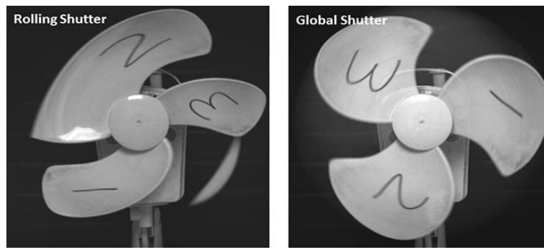
Figura 91: effetto dell'utilizzo della modalità di acquisizione immagini "Rolling Shutter" e "Global Shutter" della fotocamera Andor Zyla 5.5 (immagini tratta dalla scheda tecnica della fotocamera).
