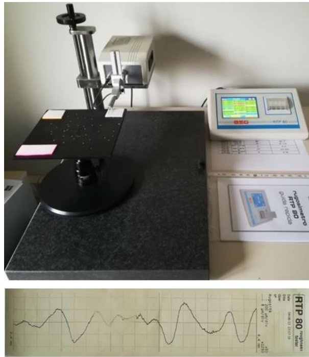
Figura 83: rugosimetro utilizzato per la misura della rugosità superficiale lineare, sul piano di misura sono presenti i 3 provini utilizzati. In basso il risultato (profilo della superficie lungo un segmento) di una delle prove eseguite.
