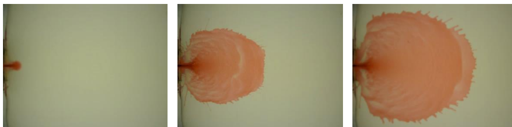
Figura 119: esempio di evoluzione di un'onda di dam-break su fondo liscio ( H_0=0.30\text{m} ); 3 scatti a circa 0.8s l'uno dall'altro a partire dal secondo scatto successivo al sollevamento della paratoia (5fps).
