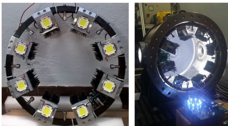
Figura 109 Anello LED realizzato
