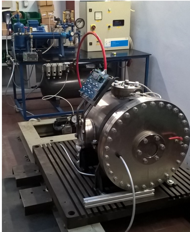
Figura 114 Camera di iniezione
