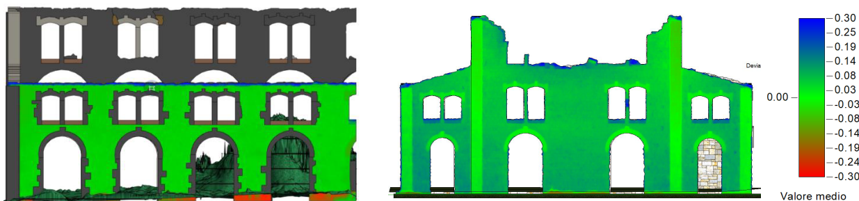
Figura 4 e 5. A sinistra esempio della valutazione degli scostamenti sulla parete ovest, in cui si vede chiaramente che gli scostamenti maggiori sono presenti sotto la quota del terreno dove, ovviamente, non erano presenti i valori della nuvola di punti. A destra scostamenti registrati nei profili delle parti crollate.
