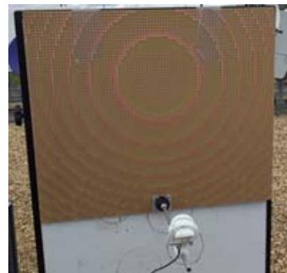
Fig. 5. Reflectarray prototype.
