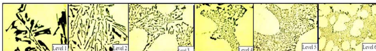
Fig. 2 – Livelli di modifica microstrutturale del silicio (43,44)/ Silicon microstructural modification levels (43,44).
