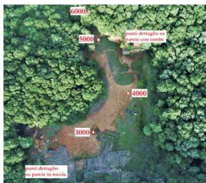
Figura 2 - Indicazione dei vertici della rete di inquadramento con le relative coordinate e precisioni.
