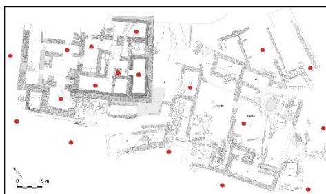
Fig. 8- Rocca di Entella, area del palazzo fortificato e dell'edificio inferiore. In rosso la localizzazione dei 18 punti di scansione
