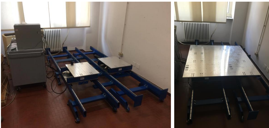
Figure 1. Shaking table at Politecnico di Torino.
