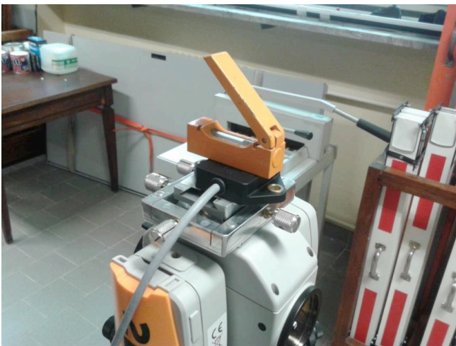
Figura 4: verifica dell'accuratezza dell'inclinometro 4030
