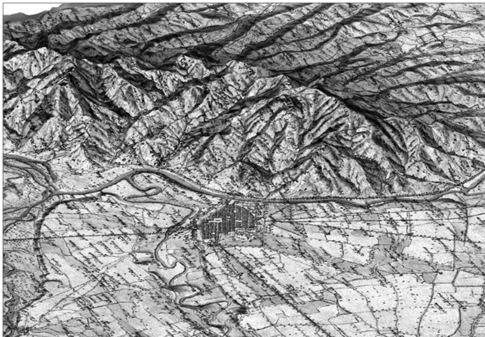
Fig. 3. Modellazione 3D della Carta degli Stati Sardi , foglio M.10 - Torino sul modello digitale del terreno ottenuto da scansione LIDAR. Visualizzazione da nord-ovest con in primo piano il tessuto urbano e alle spalle il rilievo della collina di Torino.
