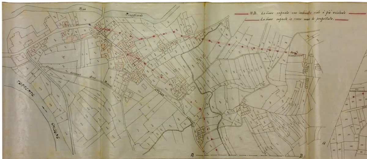
Figura 6. Estratto della Domanda per la concessione impianto/linea di allacciamento/per fornitura luce (26/01/1928, scala 1:1500), in cui si vedono le linee esistenti e quelle in progetto negli anni della nuova espansione della fornitura nel Comune (AW, Serie 7, Sott. 1, F. 161).
