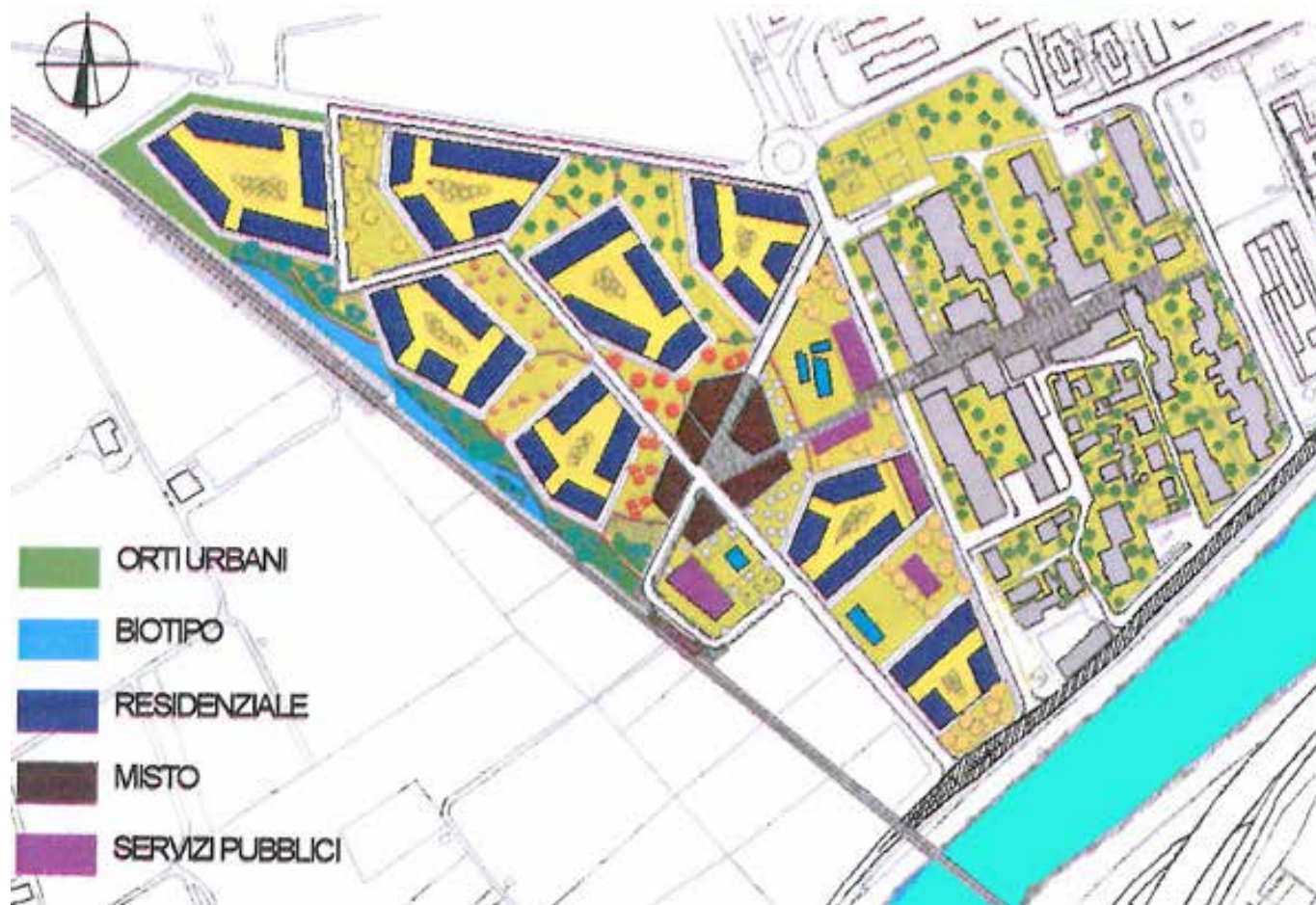
Bolzano, quartiere Casanova. Planimetria generale dell'intervento, con la fascia vegetata di rispetto tra la ferrovia e gli edifici, le aree di infiltrazione per l'acqua meteorica, gli orti urbani e le pavimentazioni drenanti negli spazi aperti dei lotti (dalla Relazione tecnica di progetto del quartiere Casanova, 2004).
